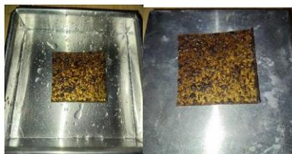
Gambar 5 Pengujian Ketahanan Cipratan Air (Sumber: Dokumentasi Penulis 2024)
