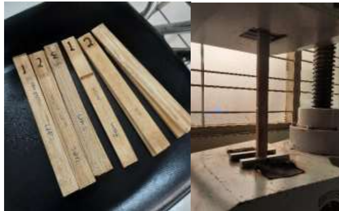
Gambar 1 Pengujian daya rekat tiga jenis perekat berbeda.
