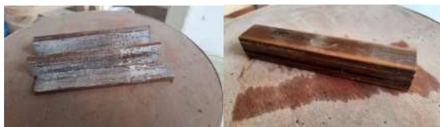
Gambar 2 Perbedaan kualitas rekat lem UF yang mudah mengelupas dan lem Epoxy resin yang tidak mudah mengelupas
