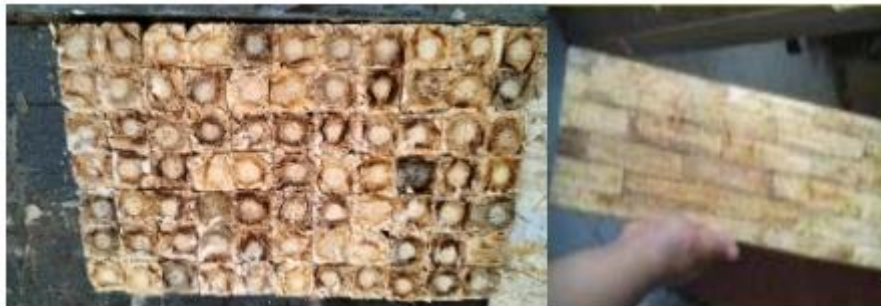
Gambar. 2 contoh hasil proses laminasi bonggol jagung ( sumber : dokumentasi penulis)
