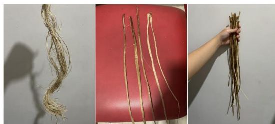
Gambar 3 . Dokumentasi eksperimen pengolahan eceng gondok menjadi benang. Sumber: pribadi
