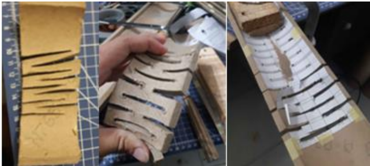
Gambar7. Eksplorasi Auxetic dan Kerf Cut pada Paper core (Sumber: Dokumen Pribadi)
